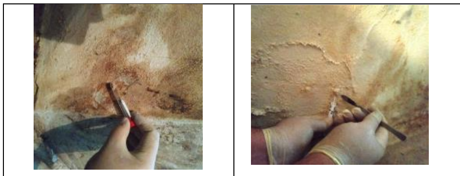
Рисунок 10. Відбір проб з ушкоджених стін в стерильні пробірки
